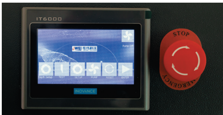
Рядом с сенсорной панелью управления располагается клавиша аварийной остановки
