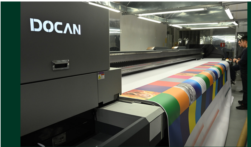
Линейный магнитный двигатель для перемещения каретки позволяет Dosan FR5000 печатать со скоростью до 80 м 2 /ч
